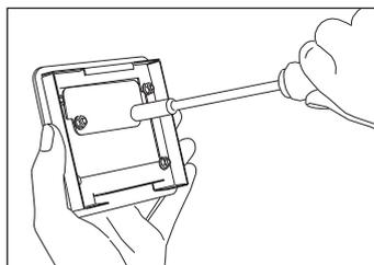
Um das Namensschild beschriften zu können, lösen Sie lediglich die zwei Muttern mit einem Steckschlüssel M4. Wir empfehlen die Beschriftung des Namensschildes vor der eigentlichen Montage vorzunehmen. Die Beschriftung kann mittels Gravur, Klebeschrift oder von Hand mit wasserfestem Stift erfolgen. Das Beschriftungsfeld ist 60 x 15 mm (BH) groß. Orientieren Sie sich bei der Beschriftung an den schwarzen Hilfslinien. Ersatznamensschilder können unter der Bestell-Nr. 30900 nachbestellt werden. /
