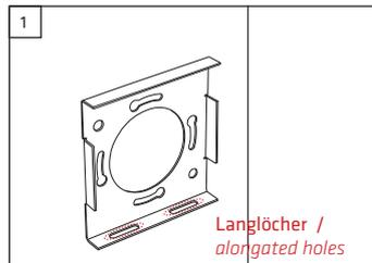
Positionieren Sie den Wandbefestigungsrahmen an der Wand. Die beiden Langlöcher im abgewinkelten Rahmen müssen unten liegen. / Position the wall mounting frame on the wall. The two alongated holes in the angled frame must be down.
