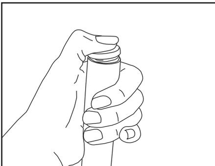
Kunststoff-Abdeckstopfen (1) auf obere Enden der Säulen stecken. / Put the plastic cover plug (1) on top of the stands.
